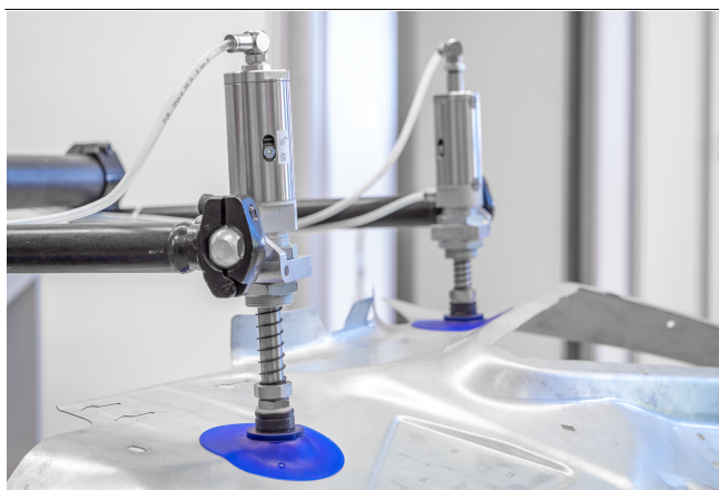
Tige élastique FST-LOCK-HD lors de la manipulation d'une pièce automobile
